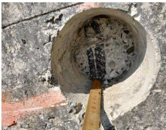
Fig.5.1 – Misurazioni dirette dei diametri e dei copriferri delle armature
